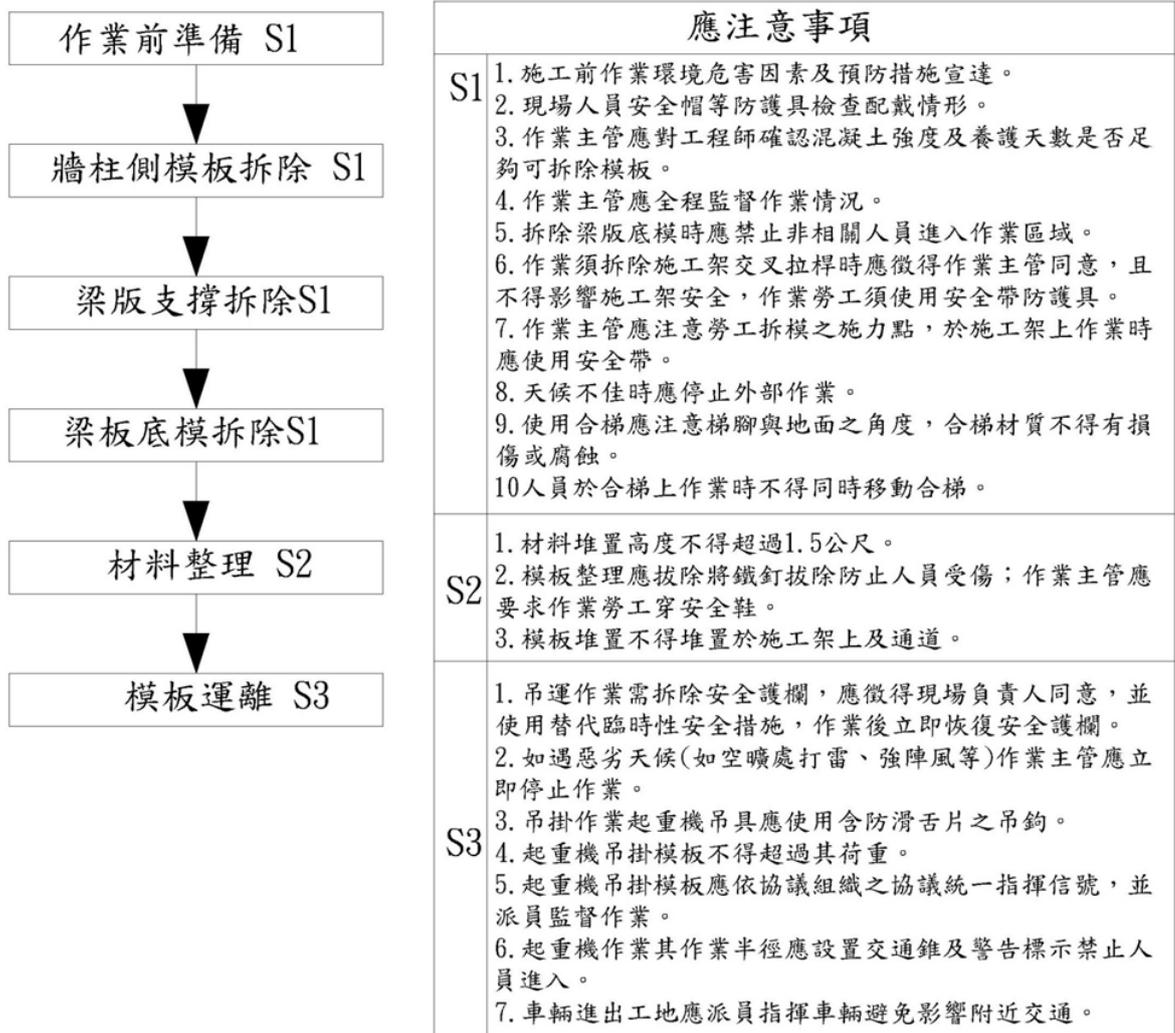
圖 6- 5 模版拆除流程及安全作業標準圖
