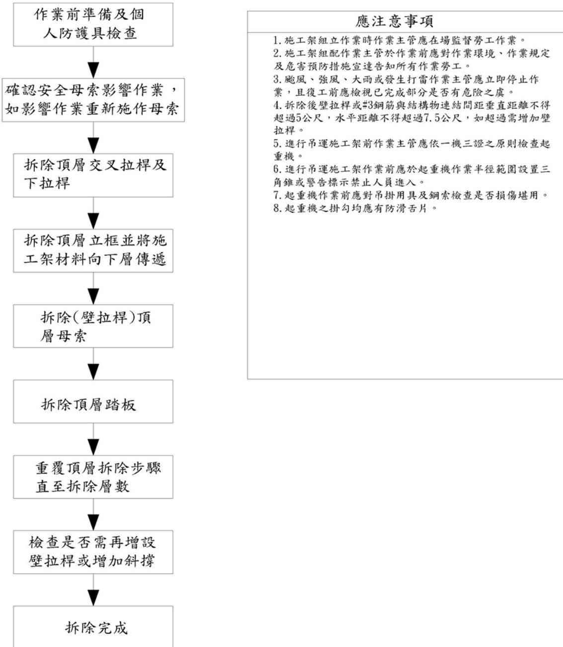
圖 6- 7 施工架拆除流程及安全作業標準圖
