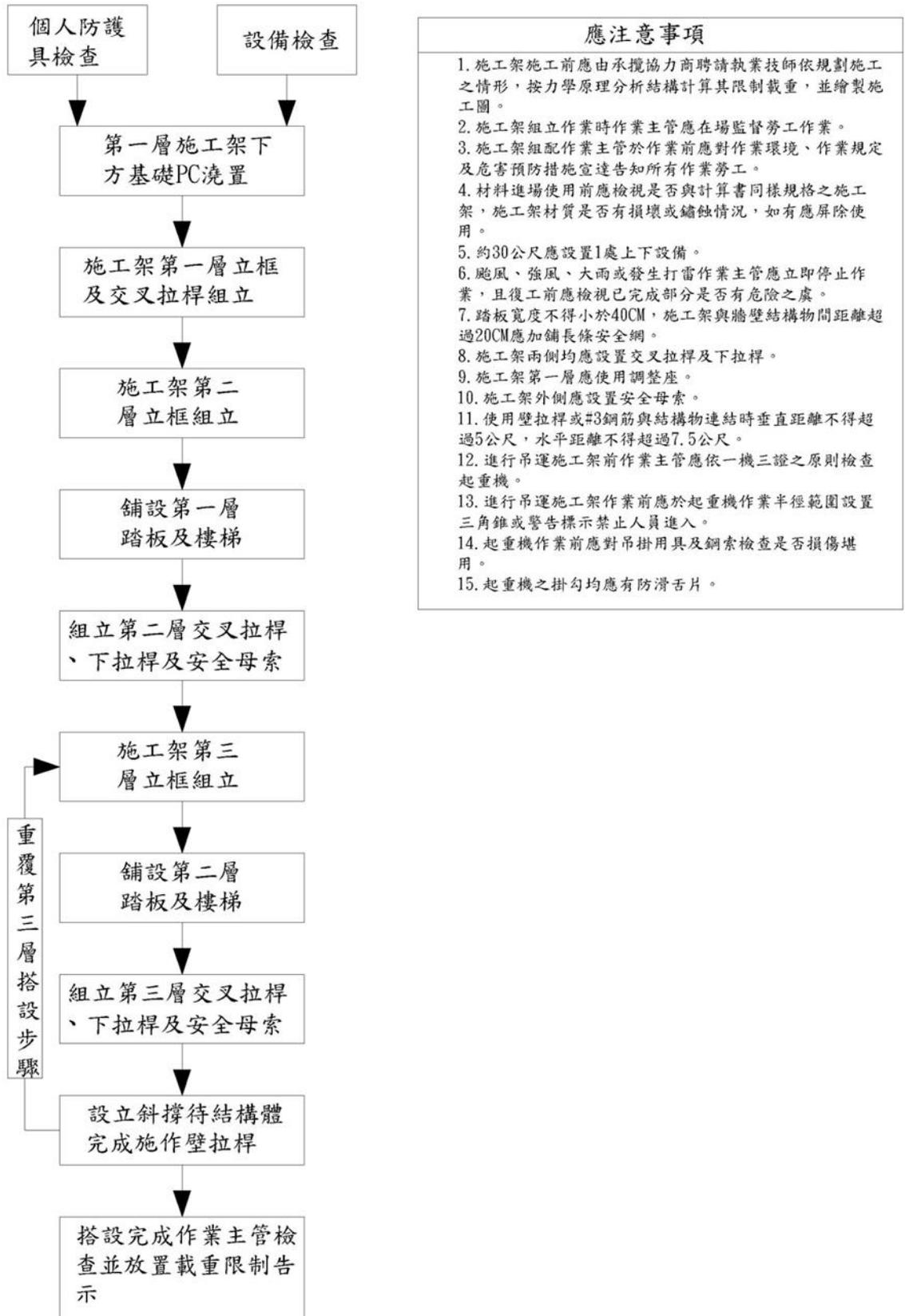
圖 6- 6 施工架組立流程及安全作業標準圖
