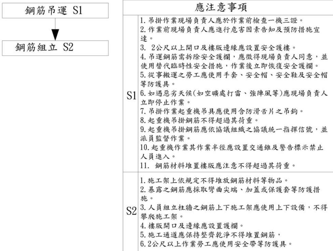
圖 6- 3 鋼筋作業流程及安全作業標準圖
