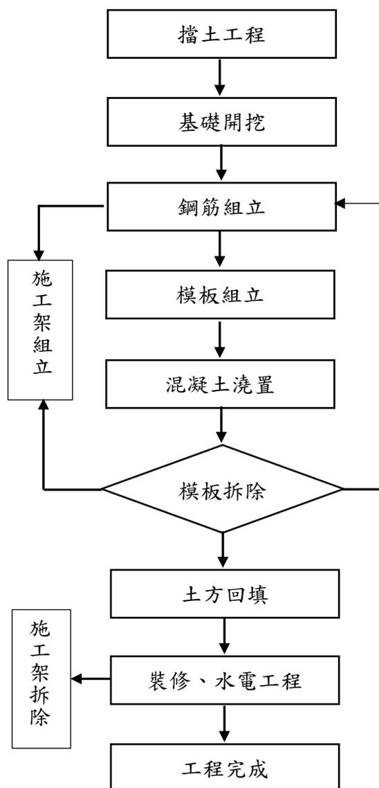
圖 6- 1 整體工程施工順序
