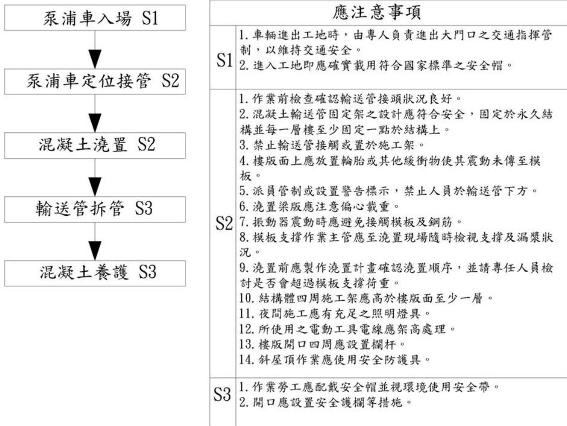
圖 6- 2 混凝土澆置作業流程及安全作業標準圖
