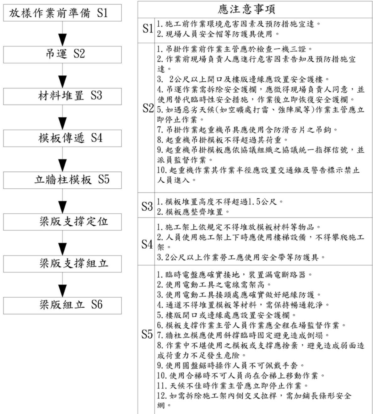
圖 6- 4 模版組立流程及安全作業標準圖
